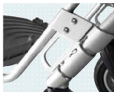
Регулируемая по высоте подножка с набором крепежей для перевозки в транспортном средстве ребенка, сидящего в коляске
